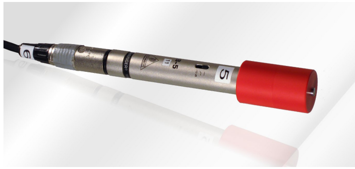
Abb. A.1.: Behringermikrofon mit aufgesetzter Kappe, die zur Eigengeräuschmessung die Membran luftdicht abschließt.
